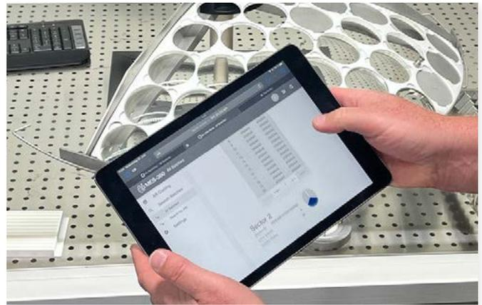
MES-360 Coating Batch, rastreia as lentes durante o processo de revestimento
