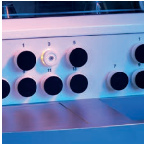
Área de armazenamento de moldes flexíveis com indicadores de vida útil e seleção
