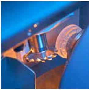
Proceso de fresado rápido con 24.000 RPM.
