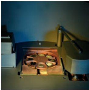
Canhão de íons com shutter, canhão de feixe de elétrons (EBG) com crucible e obturador removíveis e fonte térmica (da esquerda para a direita)
